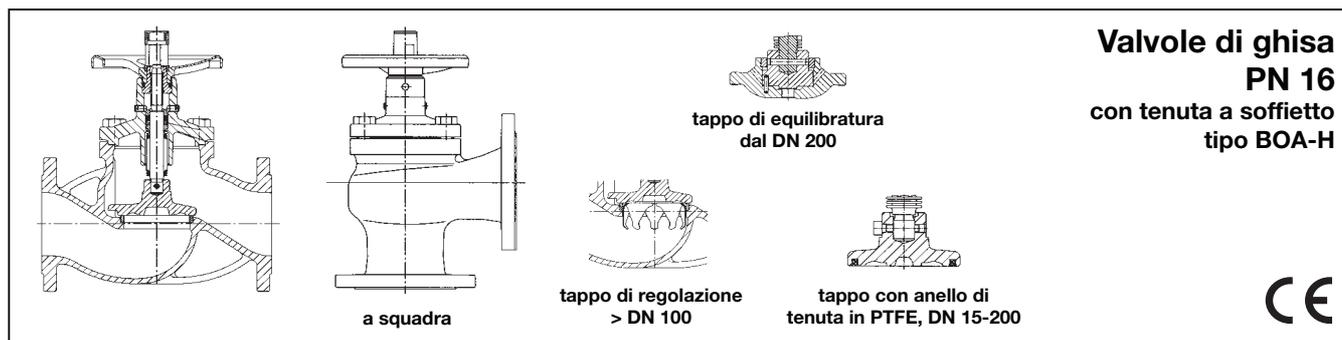
**Valvole di intercettazione con tenuta a soffietto, esenti da manutenzione, originali KSB**
